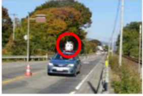
車載装置による路面性状測定
