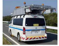
3次元レーザセンサ を用いた舗装損傷検知
