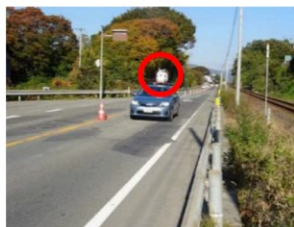
車載装置による路面性状測定
