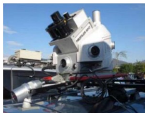
車載装置による路面性状測定
